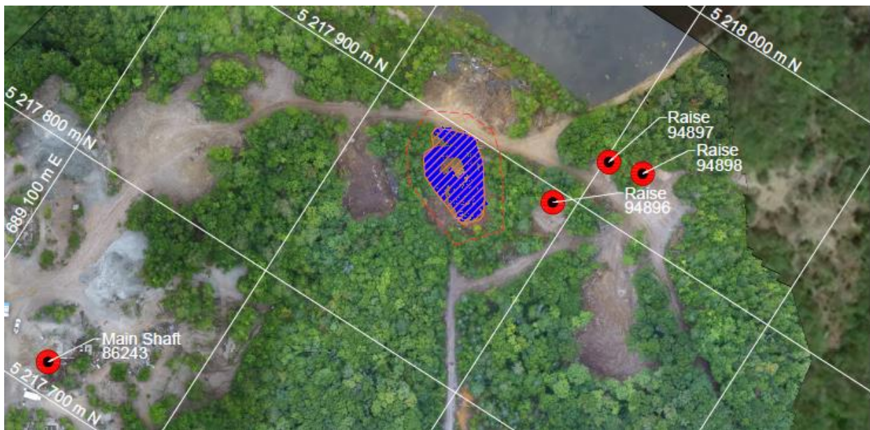
Figure 4 – Emplacement des risques miniers et du périmètre de clôture proposé (ligne pointillée rouge) dans la zone Breton (source de l'image : WSP 2023).
