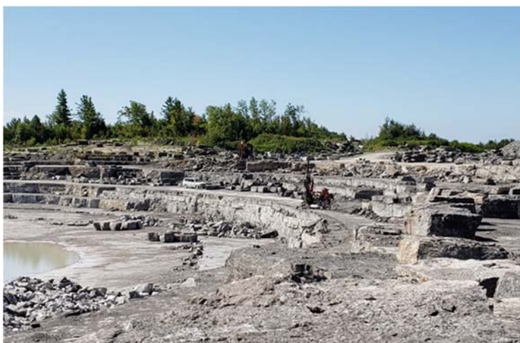
Carrière de pierre avec l'équipement pour enlever mécaniquement le substrat rocheux calcaire.
