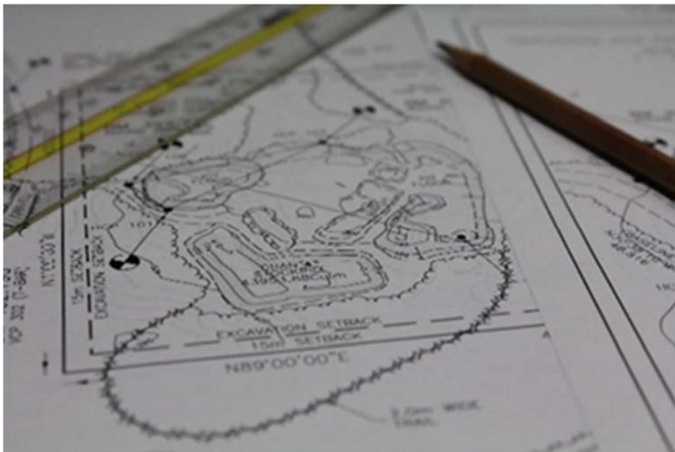
Extrait d'un plan du site montrant le retrait requis par rapport aux limites du site
